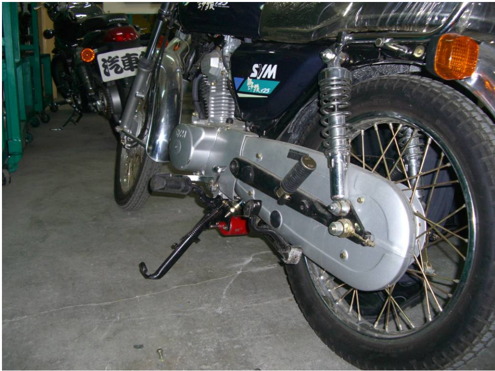
圖5-15 側支架被柱塞頂住情形一
