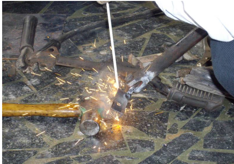
圖 5-5 焊接常閉開關支架
