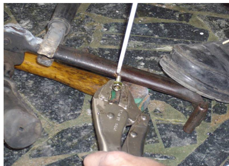
圖 5-7 焊接回覆彈簧支點
