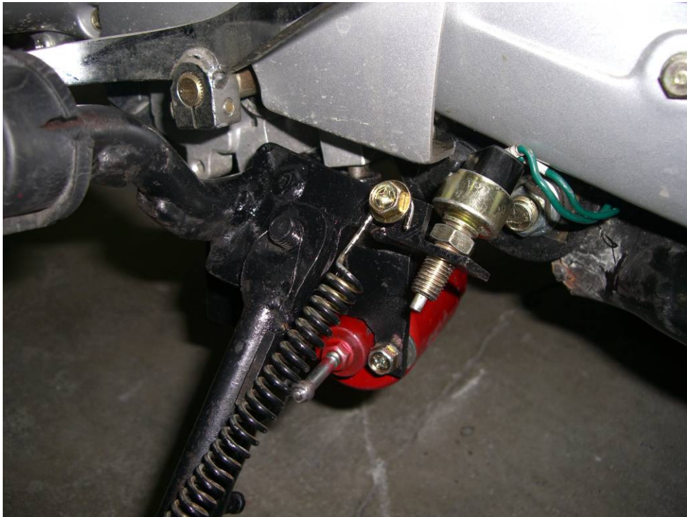
圖5-16 側支架被柱塞頂住情形二
