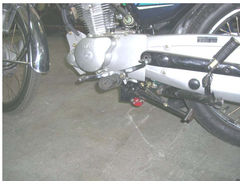
圖5-9 側支架自動收納系統實車安裝成品
