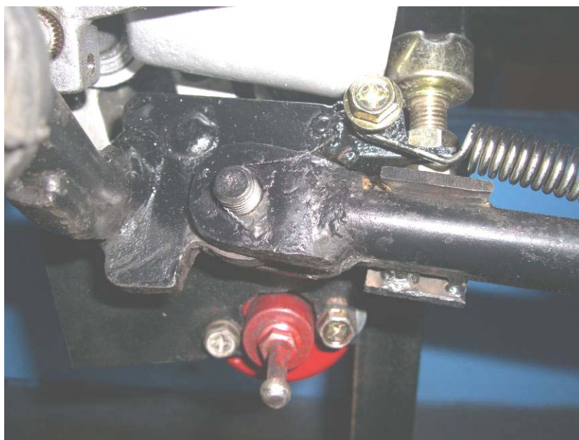
圖5-13 柱塞卡榫釋放情形二
