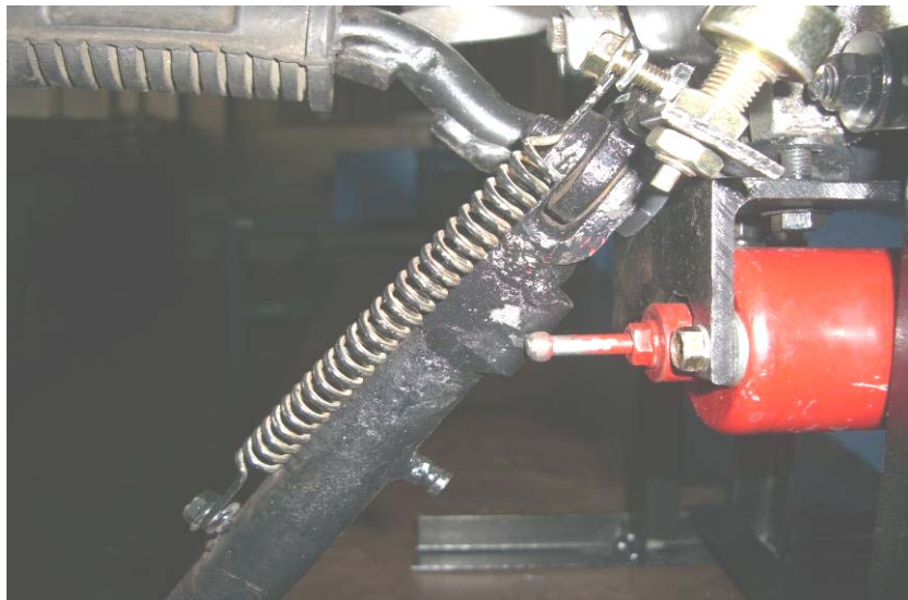
圖5-11 柱塞卡榫卡住情形二
