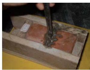
圖 2 5\text{cm} \times 5.3\text{cm} \times 11\text{cm} 的長方體模型製作砌磚灰縫控制試體模型
