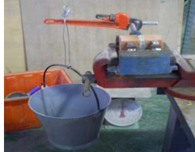
3 天、7 天剪力破壞操作設置
