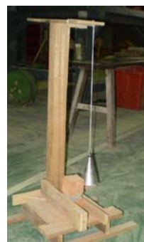
圖 3 黏結強度衝擊破壞器
