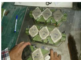
圖 1 5\text{cm} \times 5\text{cm} \times 5\text{cm} 的正立方體抗壓試體模型
